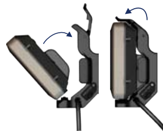
Vloženie GPSmap 620 do konzoly držiaka
