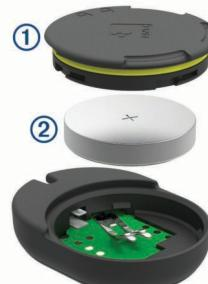
**3** Verwijder het klepje en de batterij ②.
